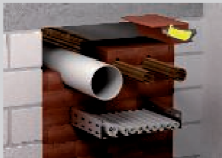
Provođenje gorivih cijevi bez dodatnih mjera zaštite.
